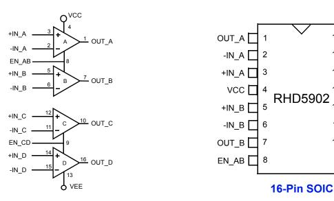
**FIGURE 1: BLOCK DIAGRAM**
